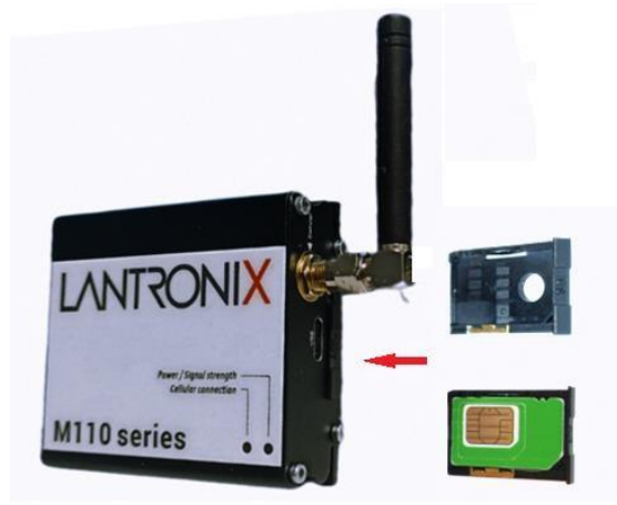
Fig. 5.1 Cartelă SIM – instalare
