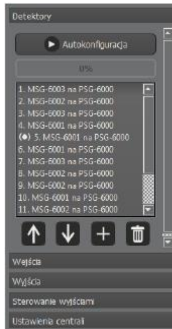
Fig. 4.2.5.2 Fereastra care arată pictograma locației la detectorul no.5. 4.3. Citirea versiunii firmware a panoului de control Pentru a verifica versiunea de firmware a panoului de control, accesați fila STARE din configurator SEDIU. În fereastra deschisă, informațiile afișate pe panoul de control și în cel din stânga jos sunt duplicate numărul software-ului încărcat în dispozitiv va apărea în colț.
