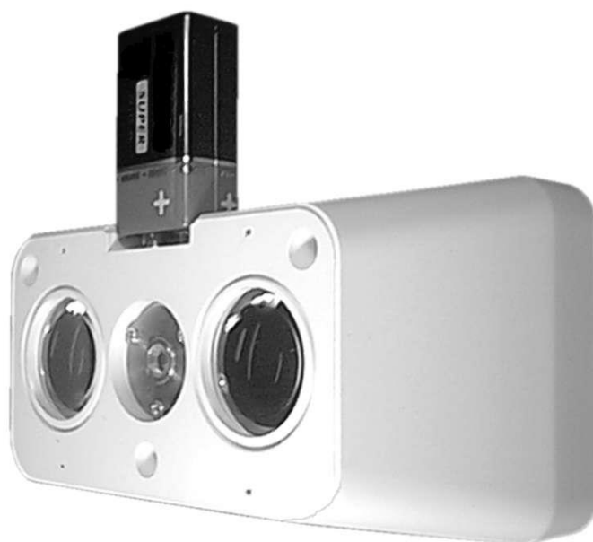
Fig. 2. Detector DOP-6001R în timpul alinierii căii optice
