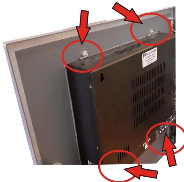
Rysunek 2.3.2/1 Śruby montażowe modułu PSO-60.
