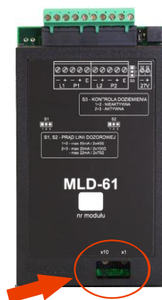
Rysunek 2.3/2 Ustawianie numeru modułu na przykładzie modułu MLD-61
