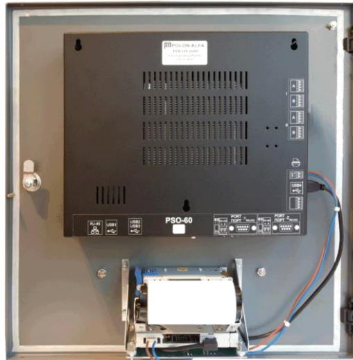
Rysunek 2.3.3/1 Umieszczenie drukarki na drzwiach
