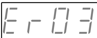
Rysunek 14. Przykład wyświetlenia uszkodzenia o numerze 3
