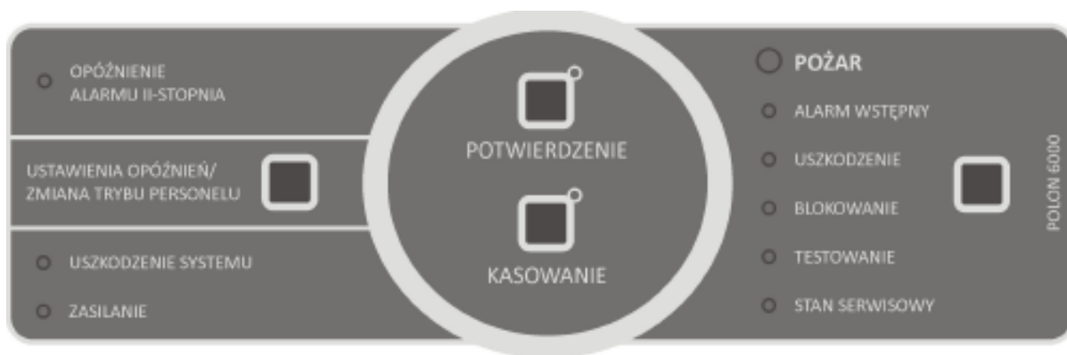
Rys. 6.3/1 Interfejs użytkownika – klawiatura + sygnalizatory
